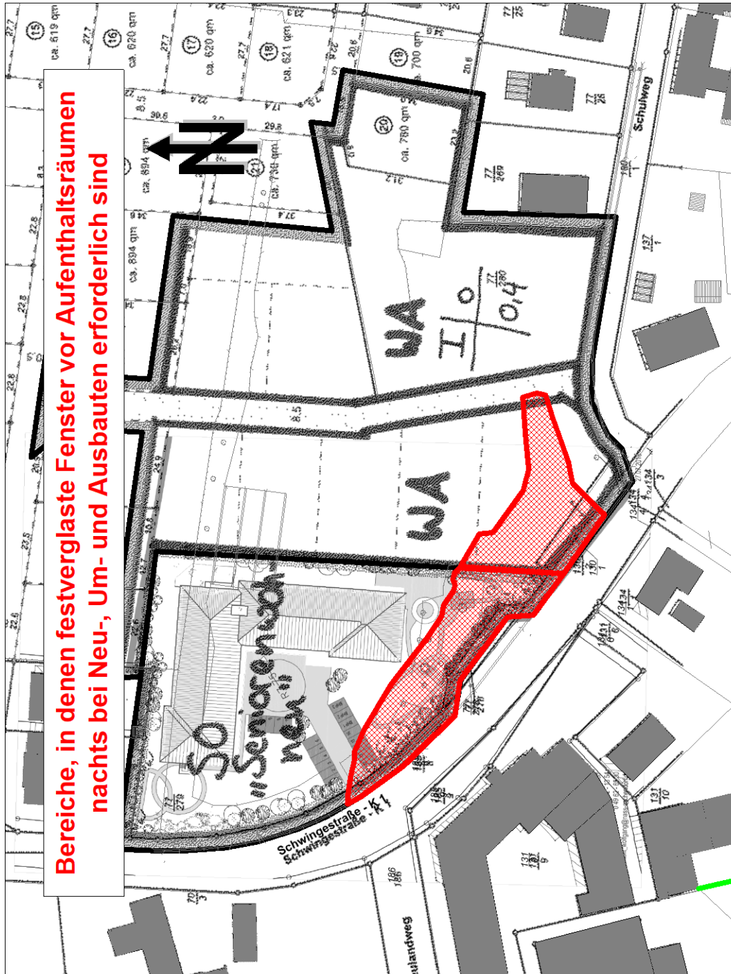
Abbildung 5: bei freier Schallausbreitung, Bereiche im Erdgeschoss des Plangeltungsbe- reichs, in denen der Immissionsrichtwert für Mischgebiet von 45 dB(A) nachts überschritten wird, Maßstab 1:1.500
