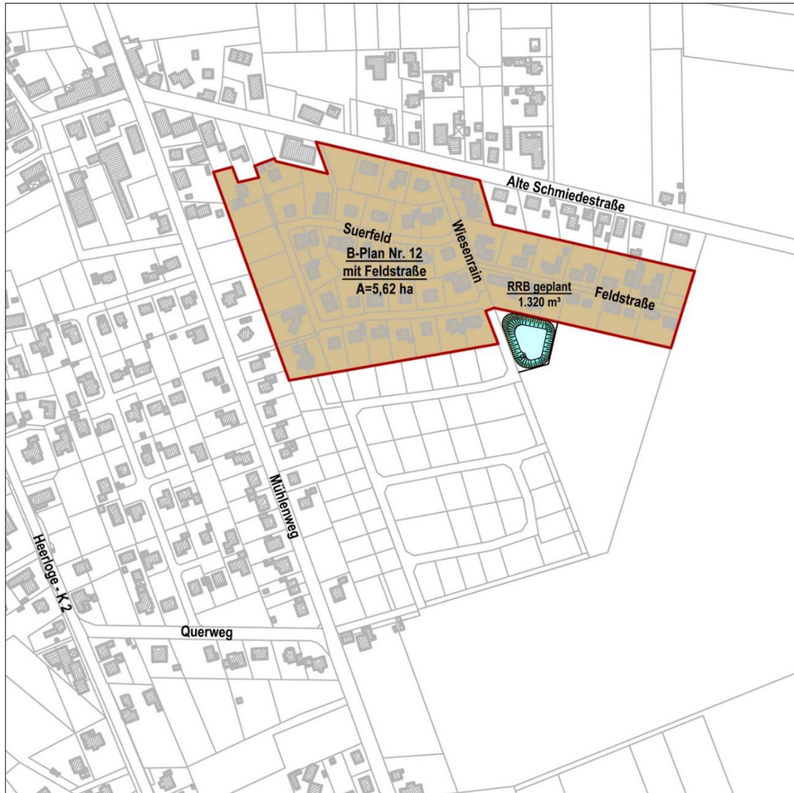
Abbildung 8: Übersicht Einzugsgebiet zwischenzeitlich zusätzlich errichtetes RRB; Ingenieurbüro Galla & Partner, 26.11.2018, ohne Maßstab
